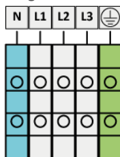
Imagem 17 - Imagem entrada de energia N, L1, L2 e L3
